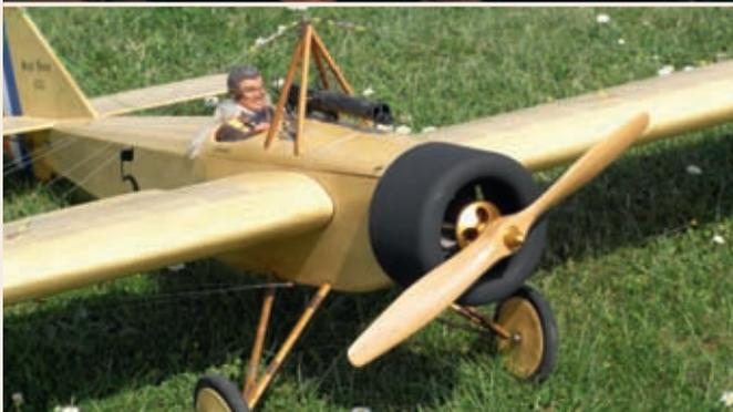
Avant, 1995 en thermique et 2006 en électrique, notez l'hélice retailée, poncée, et équilibrée...
