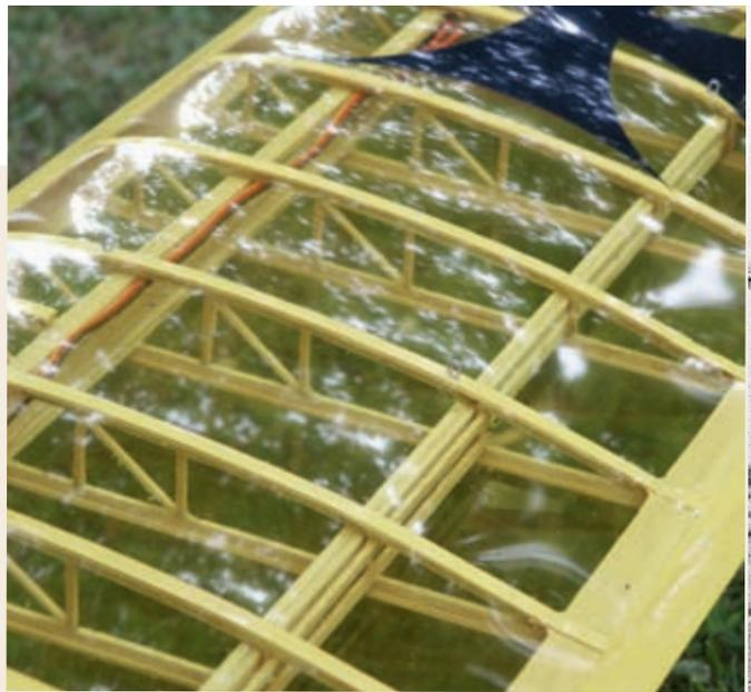
**Les nervures moulées en bloc et découpées à la scie, une autre technique que nous avons essayée avant la CNC, pas aussi rentable mais très efficace. Le bord d'attaque est en lamellé-collé de balsa-bois dur, réalisé sur forme ! Difficile, long, mais très léger et remarquablement résistant. À son coup d'essai, l'élève a dépassé le maître...**
