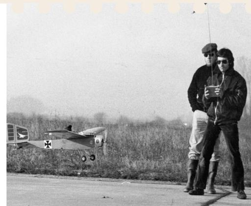
Le premier plan publié en février 1970, Radio Pilote "Microlite", 3 voies et servos plus légers. Moteur Micron 21 RC (proto usine). Le fuselage était en planche par soucis de simplicité, peu de couples. Les cotes n'ont pas varié !
