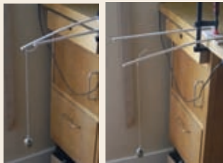
Une équerre en balsa 8 x 8 en 20/10 est équivalente à une baguette pleine de 6 x 6.
