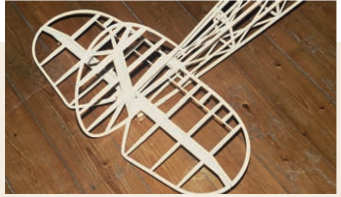
Les empennages du Stamp E, tout en lamellé collé balsa 10/10, sauf les nervures également en balsa 10/10.
