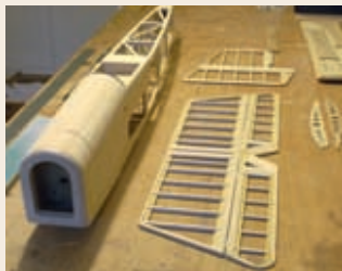
Le proto du Baron 2010 construit suivant cette technique, à ce stade 220 g... Et 150 g d'empennages !
