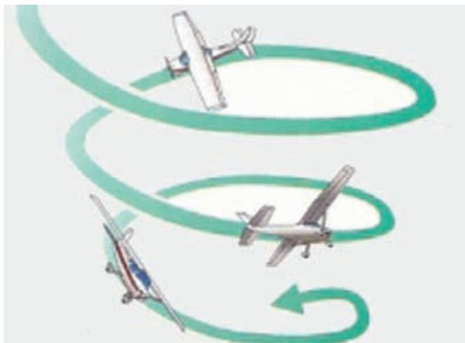
**Regardez bien la gouverne de profondeur sur ce dessin, elle a changé de fonction, en se braquant vers le haut elle ne fera "qu'amener" le nez de l'avion vers l'intérieur de la spirale. L'avion piquera de plus en plus, en tournant de plus en plus vite, et plus on "tirera" sur la profondeur pour reprendre de l'altitude et plus la spirale s'accroîtra. C'est le virage engagé ! En général, l'avion n'a pas le temps de faire un tour complet qu'il percute la planète !**
