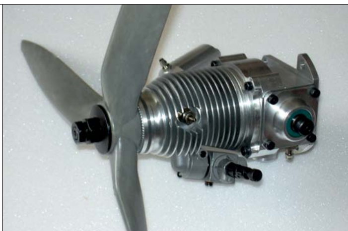
Pour certains moteurs comme le RCV conçu pour les capots effilés, la mécanique complexe demande un rodage particulièrement long, avec une hélice à très fort pas (12 inch).
