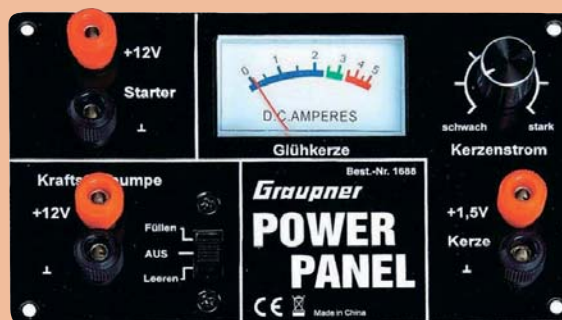
Certains Power Panel intègrent un ampèremètre, ce n'est pas un luxe, mais un indicateur précieux du fonctionnement de la bougie !
