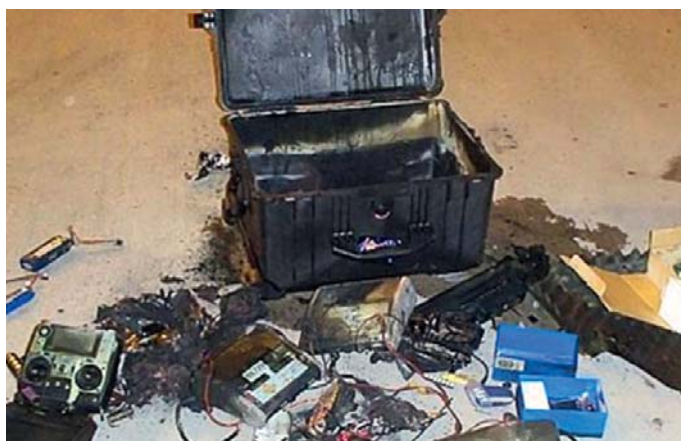
Photo des restes de bagages enregistrés après qu'une batterie a pris feu avant le décollage. Les marchandises dangereuses n'avaient pas été déclarées...
