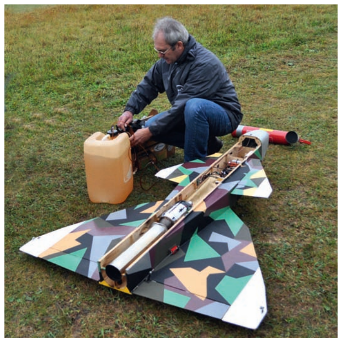
Ici, la totalité du dessus de fuselage s'enlève pour un meilleur accès à tous les éléments embarqués.
