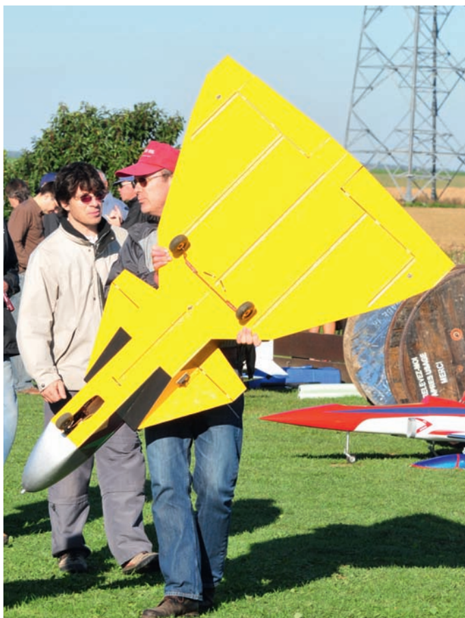
On distingue parfaitement les raidisseurs de l'aile au profil planche.
