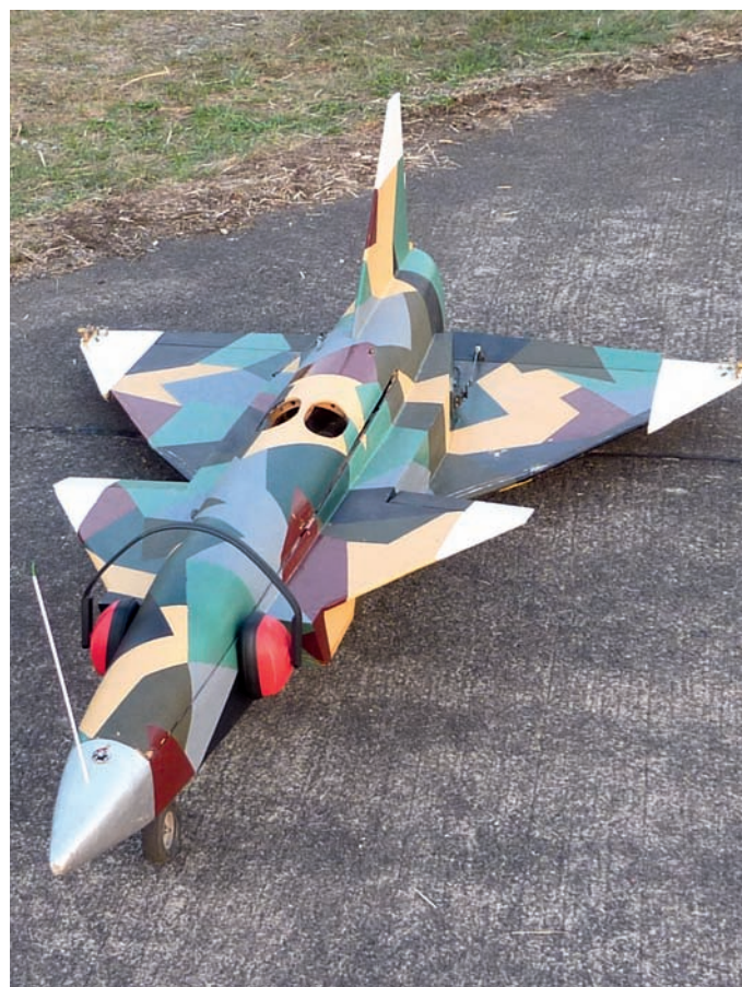
Les entrées d'air sont sur le dessus du fuselage. Pas maquette, certes, mais efficace.
