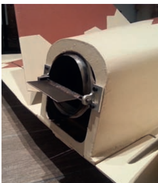
Dispositif modifiant l'angle de poussée. C'est de la poussée vectorielle simplifiée.
