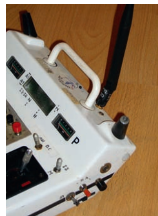
Pour ces essais, l'antenne de l'émetteur était en position verticale.
