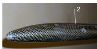
En virage à droite, c'est l'antenne 1 qui est horizontale et la 2 qui passe verticale (ici l'antenne 1 est masquée par le fuselage). Donc, quelle que soit la configuration en vol, cette disposition d'antenne en V à 90° au dessus du fuselage garantit la meilleure réception.
