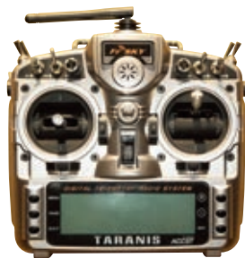
Emetteur antenne horizontale
