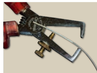
Retrait de la gaine de protection extérieure sur une antenne neuve.
