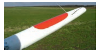
Antennes modifiées par l'auteur avec ajout de plan de masse sur un planeur Pike.
