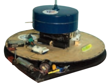
Test au banc d'essai d'une antenne avec plan de masse.
