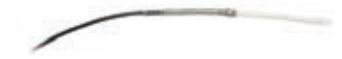
Antenne modifiée avec le plan de masse, et une gaine thermorétractable transparente pour protéger le montage.
