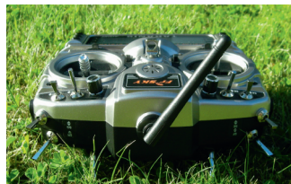
Voici ce que l'on entend par "antenne à 45°".
