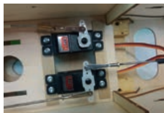
Les tiges de commande sont à présent raccordées, le plus en ligne possible. Ici, le servo de dérive reçoit un palonnier double, pour aussi commander la roulette avant orientable.
