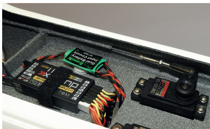
Une commande de profondeur dans un planeur de 4 mètres. Un embout fileté soudé sur la corde à piano, une chape et un contre-écrou assurent un fonctionnement optimal.
