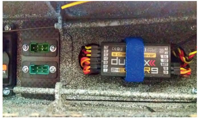
Posé sur une plaque de mousse souple ou deux pastilles d'auto-agrippant, puis immobilisé par une sangle, le récepteur ne bougera plus, et il sera bien protégé des vibrations.
