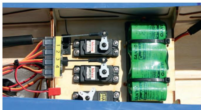
Les accus NiMh, NiCd ou LiFe n'ont pas besoin d'être démontés de l'avion pour la charge. Ils peuvent donc être fixés par des colliers en plastique.
