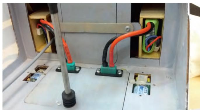
Les accus Lipo doivent être facilement démontables. Ce montage dans des boîtiers en bois (garnis de mousse fine) est très pratique.
