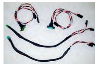
Le câblage est souvent le point faible de nombreuses installations. La réalisation de faisceaux spécifiques ajoute à la propreté et à la fiabilité du montage.
