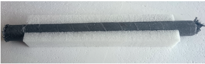
Les fourreaux de clé d'aile sont moulés en fibre de verre.
