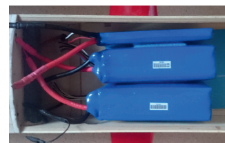
Le logement des packs d'accus permet de les avancer ou de les reculer afin d'assurer le centrage sans avoir recours à du lest.
