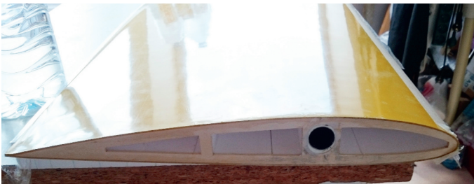
On peut voir ici les allègements dans les noyaux, et également l'état de surface obtenu avec le coffrage fibre sous mylar peint.
