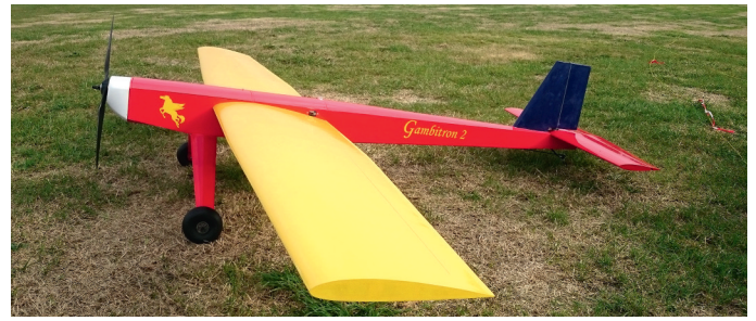
La ligne épurée du Gambitron V2 est destinée à réduire la traînée, et donc à améliorer le rendement de la cellule.
