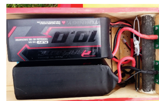
Le Gambitron V2 peut recevoir des packs de 10 000 mAh, ce qui augmente encore le nombre de remorquages possibles
