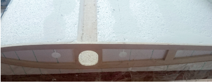
Les ailes sont très classiquement en polystyrène découpé au fil chaud.
