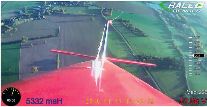
Une caméra embarquée affichant la télémétrie permet de distinguer le terrain derrière les empennages, donnant une bonne idée de l'angle de montée
