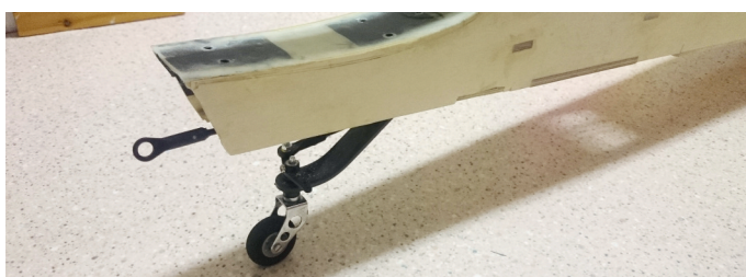
L'assise du stab et la roulette de queue.
