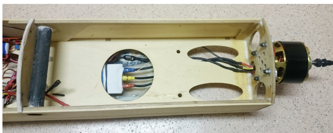
Le logement des accus est vaste et placé au-dessus de celui du contrôleur brushless.
