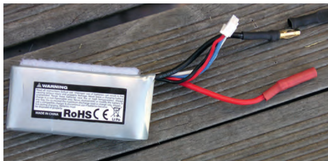
Un accu équipé d'un connecteur PK mâle et d'un PK femelle. On assure le détrompage vis-à-vis du contrôleur, mais le risque de mettre le pack en court-circuit existe.
