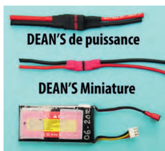
Exemples de connecteurs Deean's câblés et isolés.
