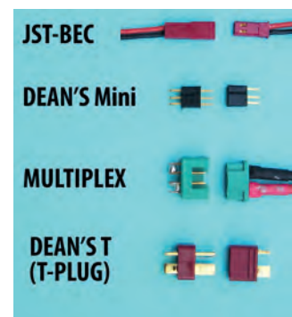
On doit choisir un type de connecteur adapté à l'intensité à passer.
