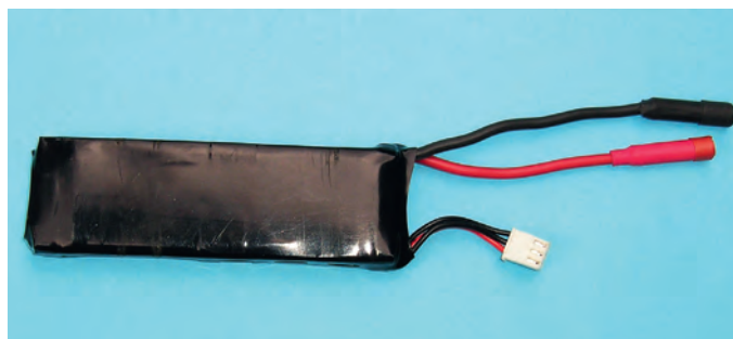
Un accu équipé de deux connecteurs PK Femelle. Seules les couleurs renseignent sur les polarités.
