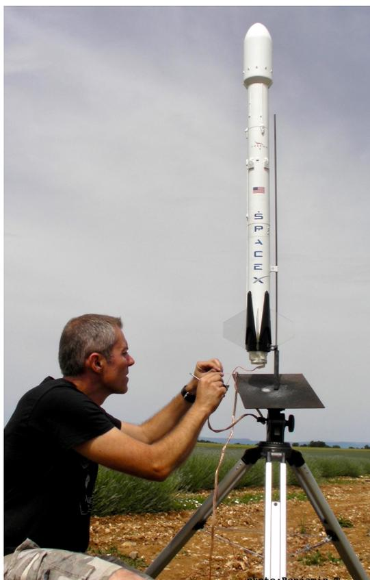
prédéterminée, le parachute principal plus grand est éjecté, ce qui va freiner la descente sur les derniers mètres et permettre ainsi un atterrissage en douceur. Cette séquence est réalisée grâce à un altimètre embarqué dans la fusée. Véritable petit ordinateur de bord, ce système assure la gestion de la récupération et collecte des données durant le vol (vitesse, altitude, accélération, etc).
