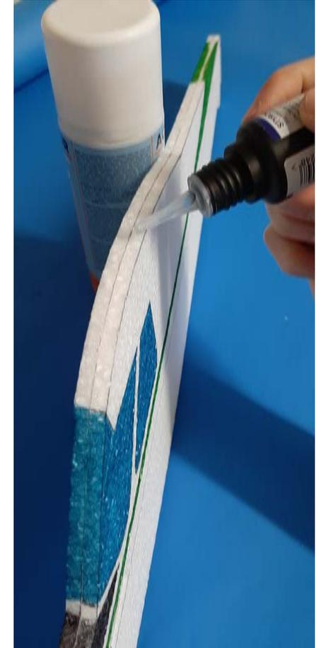
1. Appliquer la colle sur un des deux fuselages, le plus au bord possible et au centre.
